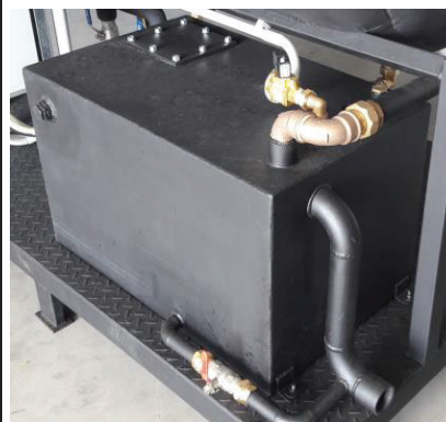
vychlazovací nádrž s dochlazením
